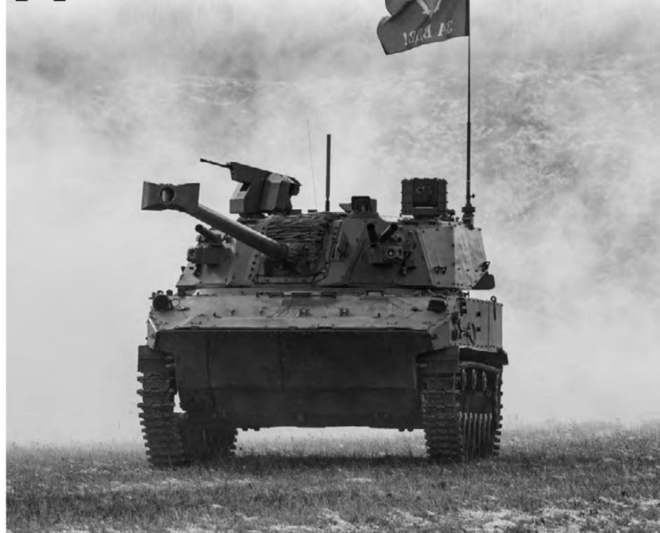
было взято шасси авиадесантируемой БМД-4М, установлена автоматизированная башня со 120-миллиметровым орудием. Экипаж состоит из 4 человек. CAO 2C42 может десантироваться в полностью боеготовом состоянии с военно-транспортных самолётов типа Ил-76 с помощью десантных парашютных систем.
